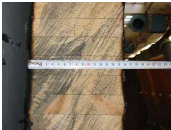
Lamelirani nosač izgubio 4 cm nakon požara
