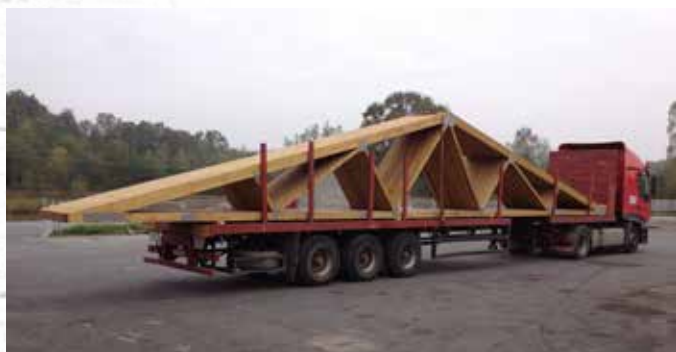
Transport rešetkaste konstrukcije
